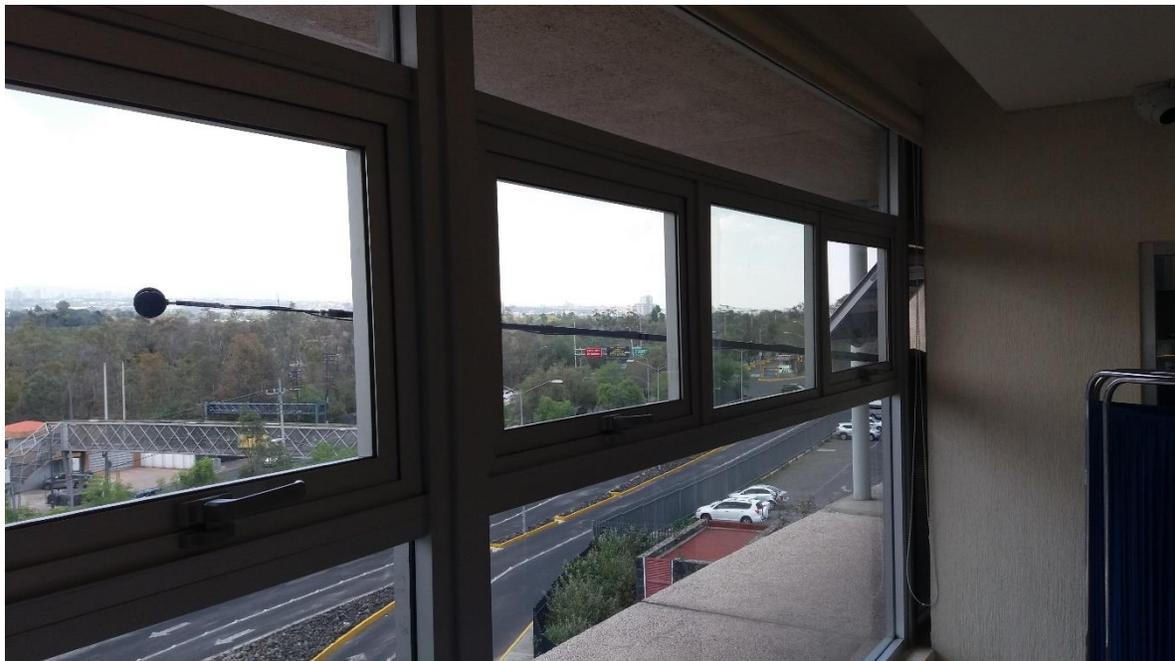
Figura 3. Posición del micrófono para medición de ruido vehicular al exterior de las aulas, frente a 2 m de la fachada, resultados ver tabla -1
