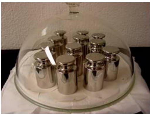
Fig. 2 Patrones de acero inoxidable con valor nominal de 1 kg
