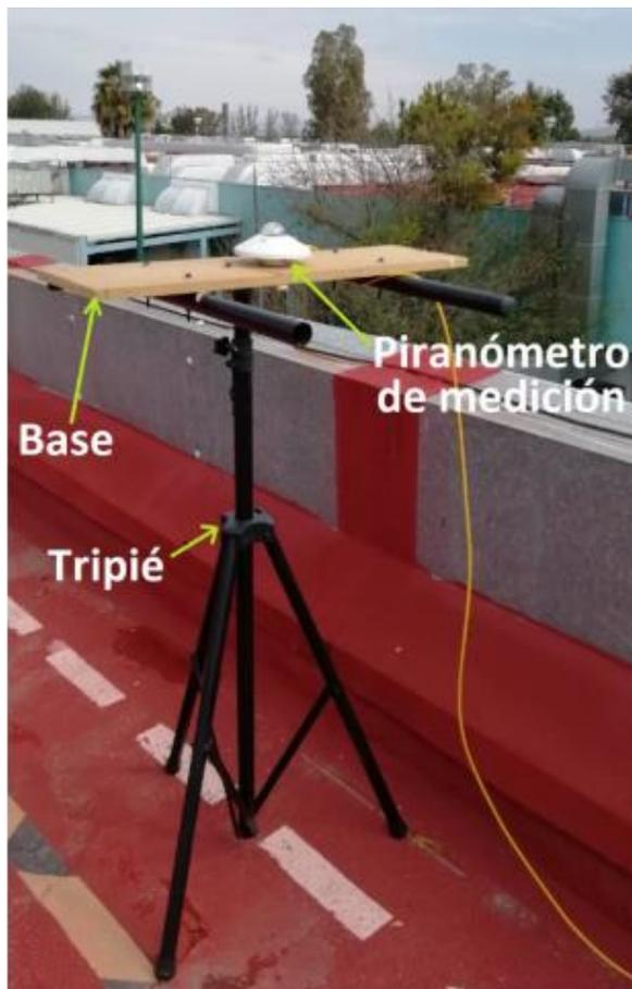
Figura 3. Medición de irradiancia en el techo del Edificio D del CENAM.
