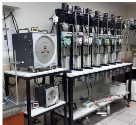
**Fig. 1.** Banco de pruebas para verificación de medidores de diafragma
