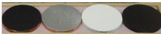
**Fig. 6.** Muestras utilizadas en la intercomparación internacional de medición de emisividad espectral entre el CENAM y el PTB.
