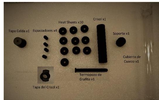
**Fig. 2:** Piezas que componen la celda de punto fijo de indio.
