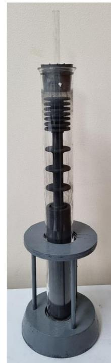
**Fig. 5:** Ensamble completo de la celda de punto fijo fabricada en el INM.
