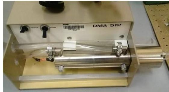
**Fig. 2.2** Celda de medición externa, modelo DMA 512 de la marca Anton Paar.
