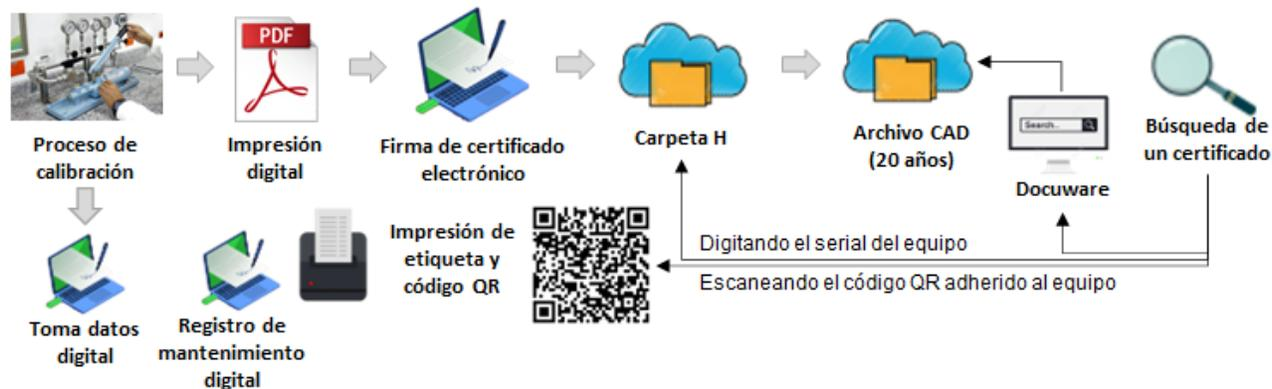
Fig. 3. Flujo documental del proceso de calibración después de la digitalización.
