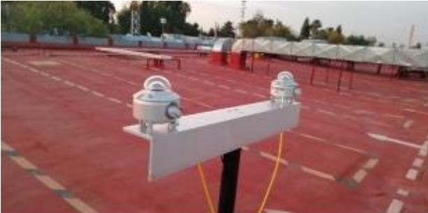
Figura 5. Medición con el piranómetro de medición (derecha) y el piranómetro de referencia (izquierda) en el techo del Edificio D del CENAM.
