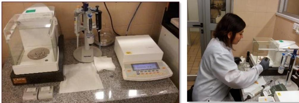
**Fig. 3.** Microbalanza bajo calibración:  $Max = 31\text{ g} / d = 0.001\text{ mg}$ . Proceso de calibración in situ.
