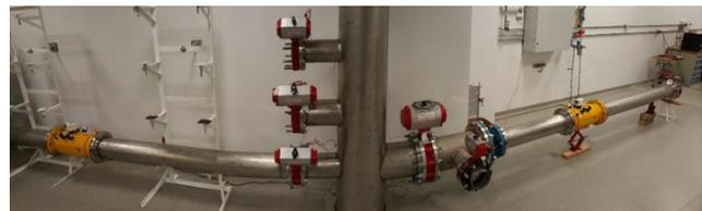
**Figura 3.** Foto de instalación del medidor G1600-2 contra el PR G1600-1.
