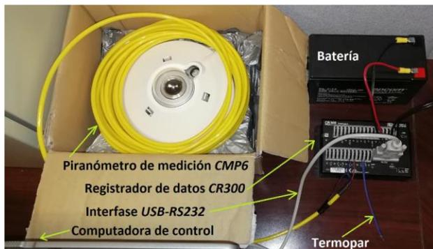
(a) Sistema de medición con piranómetro para laboratorio
