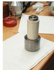
Imagen 1.- PC 108A Referencia de Presión en el intervalo de 350 kPa (Fuera de uso).
