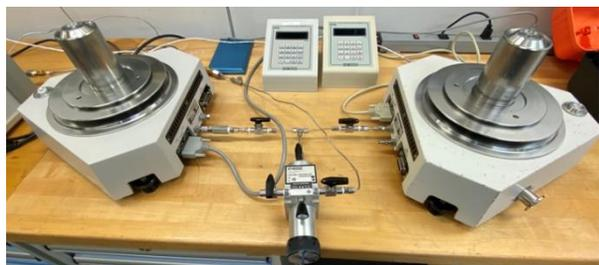
Imagen 7.- Medición por el método de flotación cruzada.
