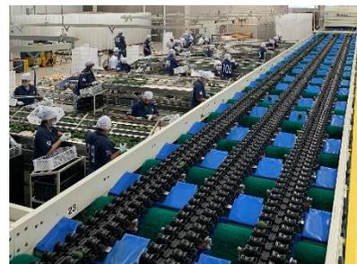
*Fig. 1. Seleccionadora ponderal sometida a calibración*
