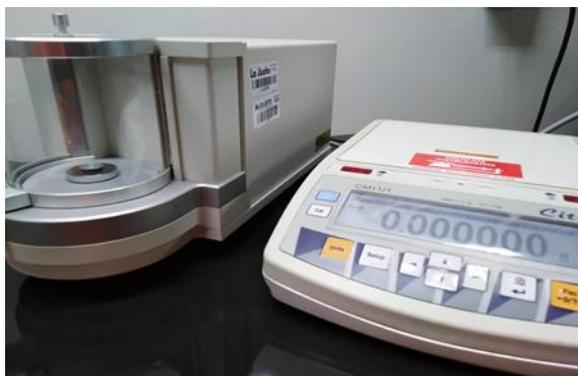
Fig. 03. Micro balanza Citizen capacidad máxima 10 g,  $d = 0,001$  mg.
