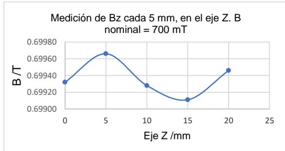
**Figura 24.** Gráfica del campo magnético en función de la distancia, para 18 mm de separación
