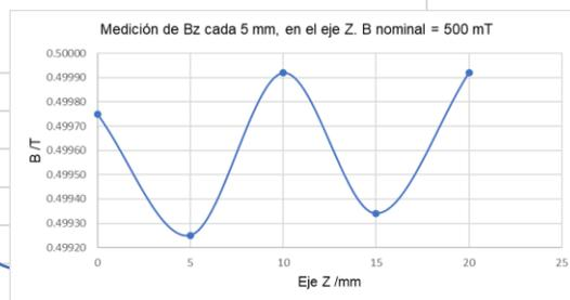
**Figura 23.** Gráfica del campo magnético en función de la distancia, para 18 mm de separación.
