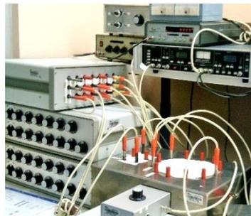
**Fig. 1.** Puente de medición de capacitancia analógico de alta exactitud Z2
