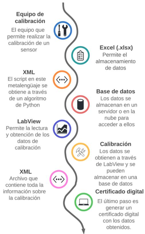
**Fig. 3. Propuesta del diagrama del proceso de calibración.**
