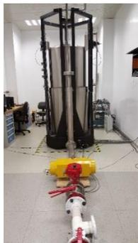
**Figura 5.** Calibración de los medidores rotativos duos modelo G100, G65 y G40.
