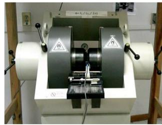
**Figura 2.** Sistema empleado para la generación y medición del campo magnético B.
