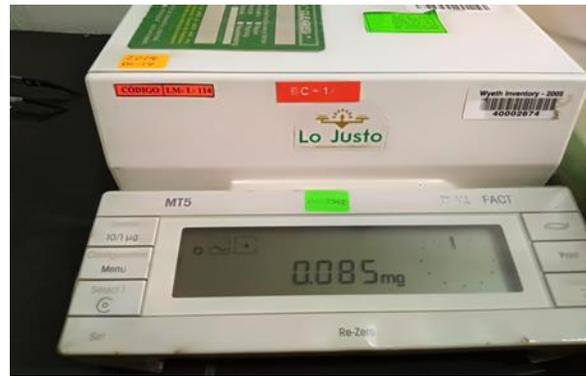
Fig. 04. Micro balanza Mettler Toledo capacidad 5 g,  $d = 1 \mu\text{g}$
