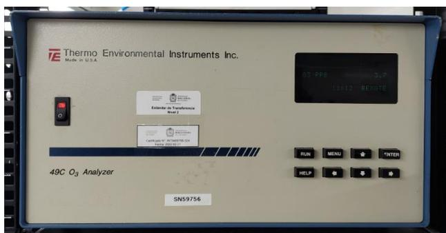
Fig. 4. Thermo 49C, Nivel 2 (patrón retenido).
