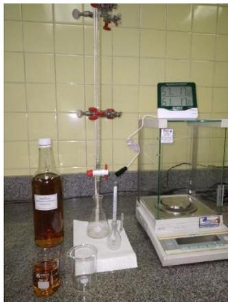
Fig. 2 Montaje para contar y pesar 50 gotas de la mezcla H.A.
