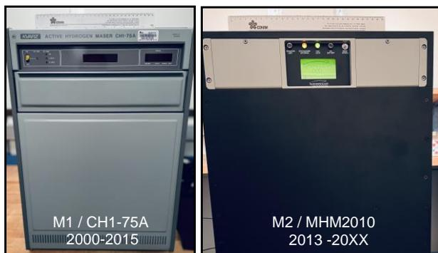
**Fig. 3.** Fotografías de los máseres de hidrógeno del CENAM (M1: izquierda y M2:derecha). Nota: La regla en la parte superior de ambas fotografías tiene una longitud de 30 cm.
