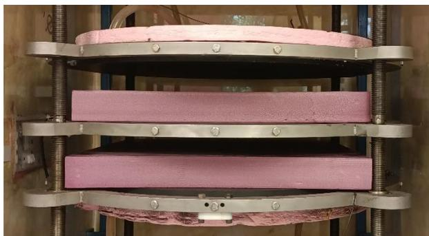
Fig. 1. Aparato de Placa Caliente con Guarda para materiales de construcción.
