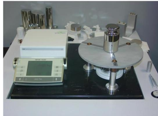
**Imagen 4.** Susceptómetro hasta 50 kg, dirección de Masa y Densidad del CENAM
