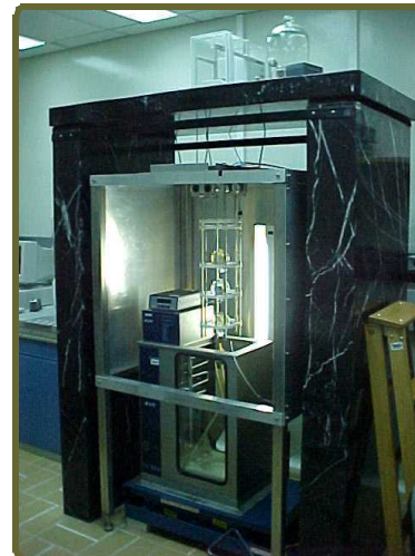
El Sistema de pesada hidrostática del Patrón Nacional de Densidad
